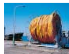
オイルフェンス(格納時)
